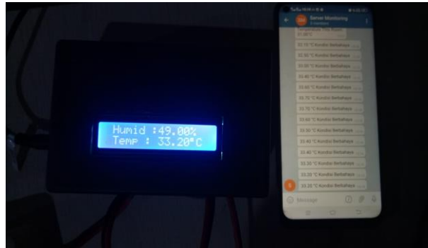
Gambar 3 Kesesuaian Nilai Suhu di BOT Telegram dan Tampilan di LCD
