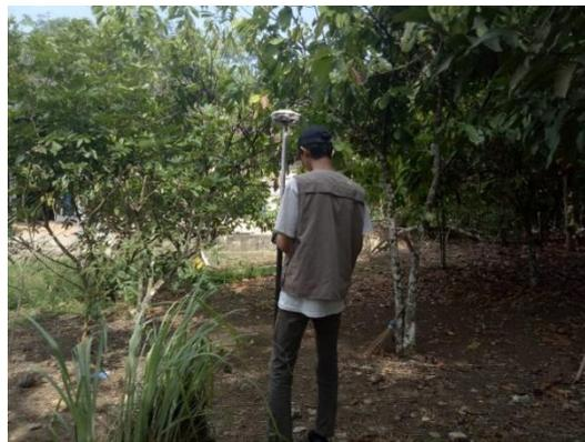
Gambar 4. Pengukuran Menggunakan GNSS *Comnav T300*
