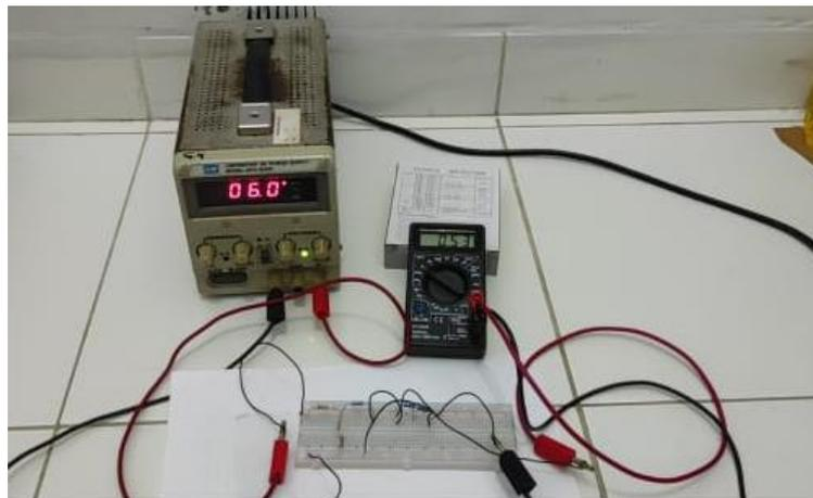
Gambar 5. Pengukuran Arus dan Tegangan Thevenin pada KIT
