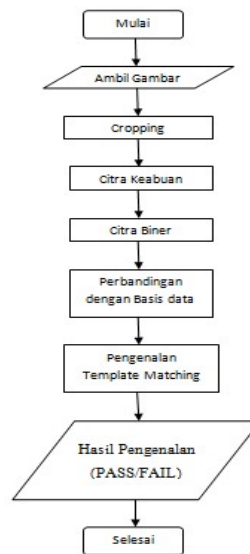
Gambar 11. Diagram alur perancangan sistem identifikasi label kode pipa
