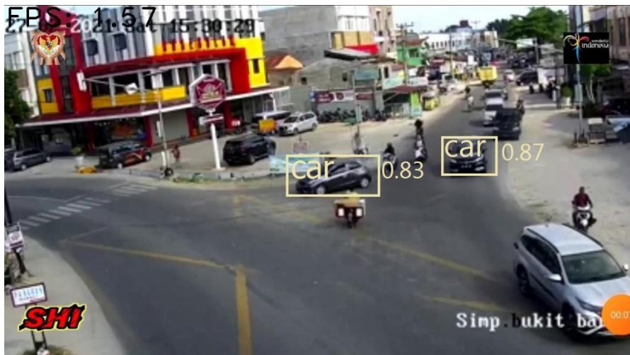
Gambar 8. Hasil pengujian menggunakan metode TinyYOLOV3 pada waktu 0 menit 21 detik Untuk
