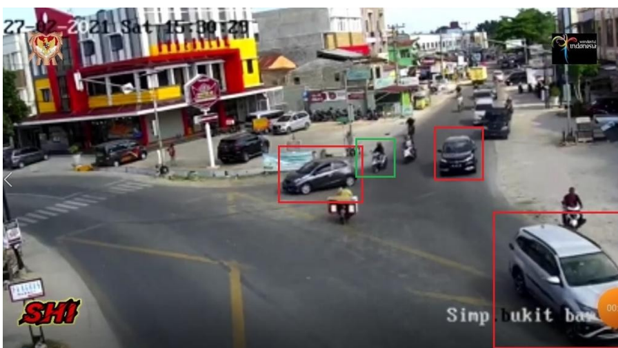
Gambar 6. Hasil pengujian menggunakan metode Haar cascade pada waktu 0 menit 21 detik
