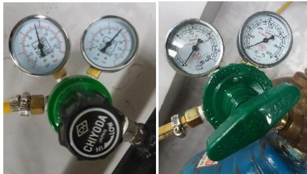
**Gambar 6.** Regulator udara bertekanan dan regulator gas O<sub>2</sub>
