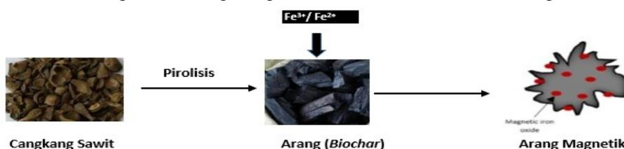
Gambar 1: Pembentukan Arang Magnetik Dari Cangkang Sawit
