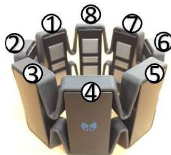
Gambar 1. Myoarm band beserta 8 buah sensor myo
