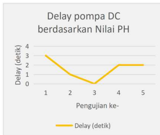
Gambar 16. Grafik pengujian delay pompa DC berdasarkan sensor PH tanah
