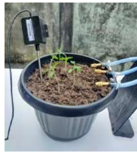
Gambar 12. Tampilan sensor PH tanah
