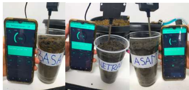
Gambar 27. Proses pengambilan data kestabilan pengukuran dengan sensor PH tanah
