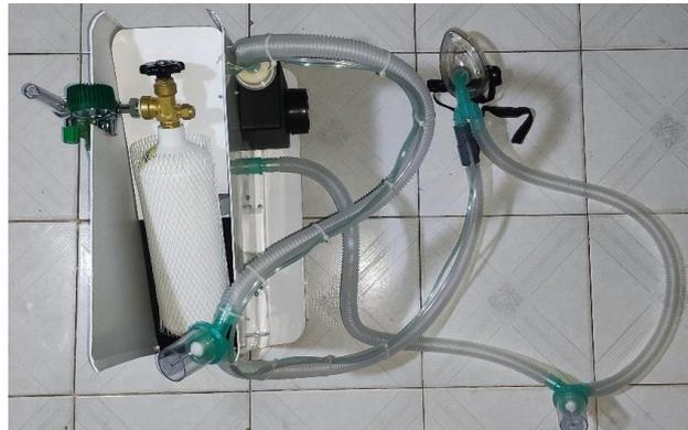
Gambar 11. Prototipe *Portable Ventilator* tampak atau
