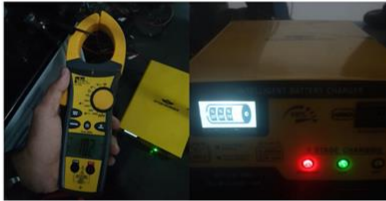
Gambar 3. Proses pengisian baterai menggunakan sumber PLN
