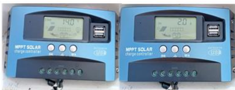
Gambar 3. Pengukuran tegangan dan arus MPPT solar
