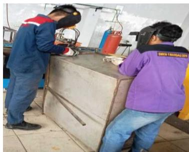
Gambar 3. Proses pembuatan dinding oven pengasapan ikan
