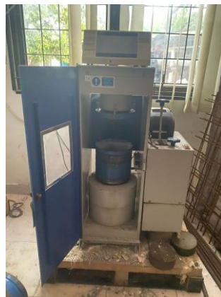
Gambar 3 . Setup Alat Uji Tekan
