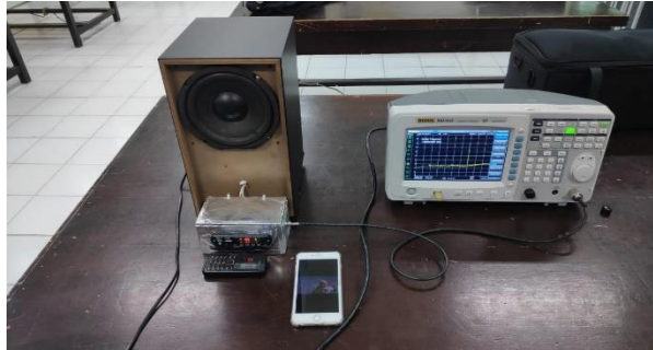
Gambar 3. Pengukuran shielding yang diaplikasikan pada sound system
